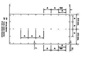
**FIJACION DE LAMINAS SEPARACION ENTRE PERFILES CADA 610 mm.**
