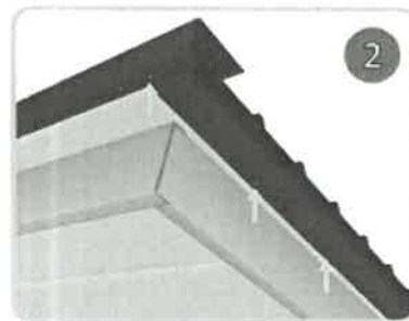
Fijar los remates frontal con tornillos auto-perforantes con arandela de neopreno de 2.5 cm (1").
