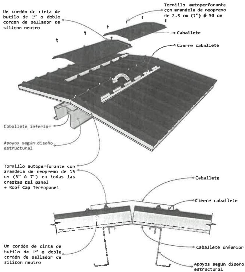
● Detalles de instalación de elementos en la cumbre, extremos
