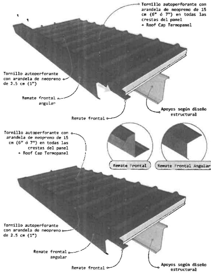
● Detalles de instalación de solapa frontal "Flashing"
