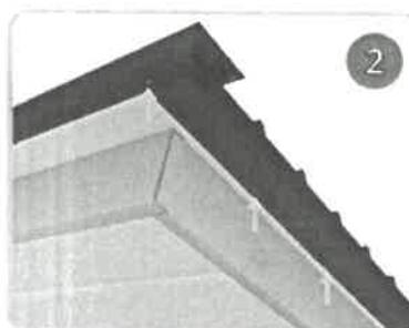
Fijar los remates frontal con tornillos auto-perforantes con arandela de neopreno de 2.5 cm (1").
