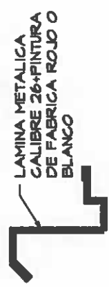
REMATE LATERAL DT-7 AR-5 Esc. 1/5
