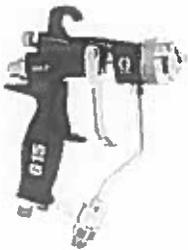
Una aire en boquilla a la descompresión del sistema Airless, lo que reduce substancialmente las presiones de trabajo y, por tanto, subsana en parte los problemas del Airless, manteniendo todas sus ventajas.
