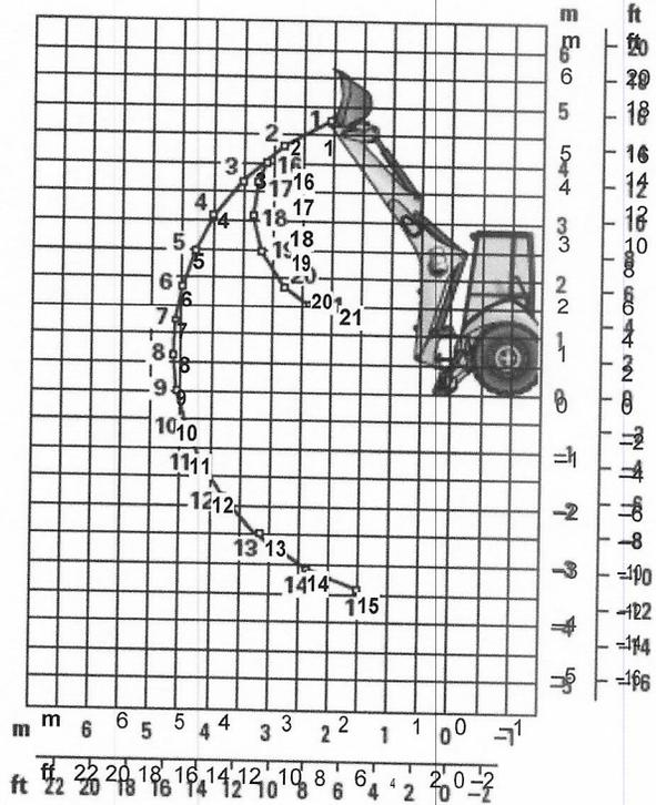
Las capacidades de levantamiento son valores en el extremo del brazo de la máquina. Máquina equipada con 4x4, ROPS, cucharón de uso general 0.76 m<sup>3</sup> (1.00 yd<sup>3</sup>) [sin contrapeso].
