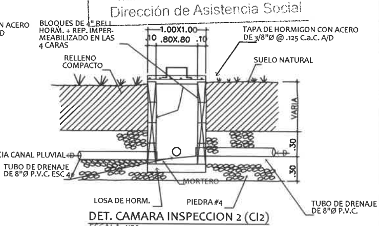
DET. CAMARA INSPECCION 2 (C2) ESCALA: 1:35
