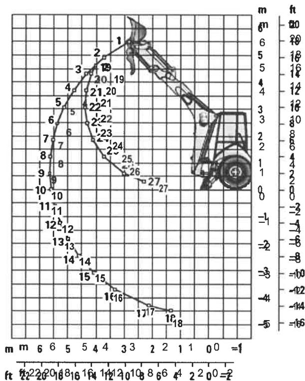
Las capacidades de levantamiento son valores en el extremo del brazo de la máquina. Máquina equipada con 4x4, ROPS, cucharón de uso general 0.76 m<sup>3</sup> (1.00 yd<sup>3</sup>) sin contrapeso. El brazo extensible incluye contrapeso de 460 kg (1,015 lb).
